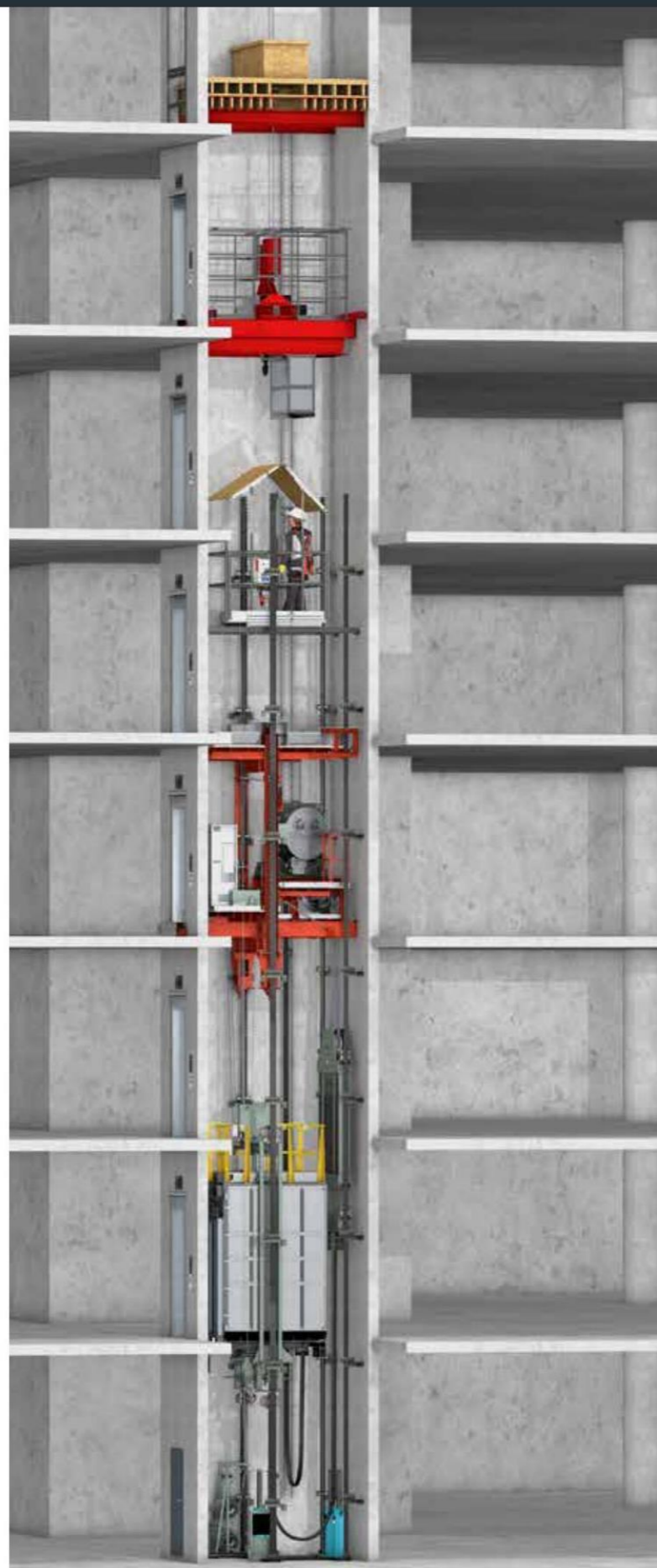
Het Schindler CLIMB Lift™ principe.
